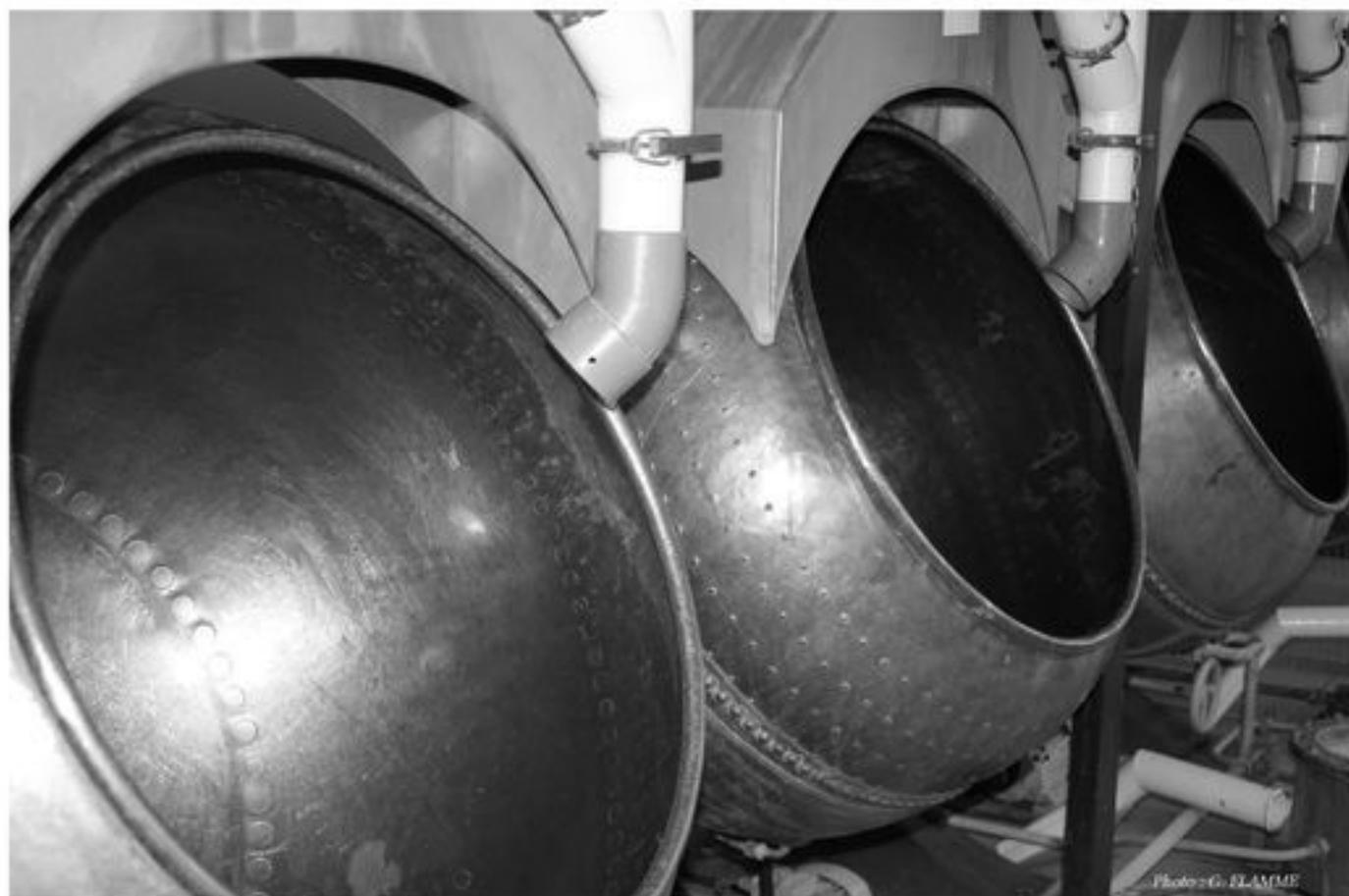
Ce procédé, de médiocre rendement, fut employé jusqu'en 1860, année où fut inventée par J.J. Jacquin la "machine à dragées". C'est un gros récipient de cuivre de forme sphérique tournant sur un axe incliné. Une large ouverture permet au dragéiste de verser des sirops successifs sur les noyaux agités de mouvements parfaitement réguliers. C'est simple, en théorie, mais la surveillance de telles "turbines" exige un personnel hautement qualifié.
